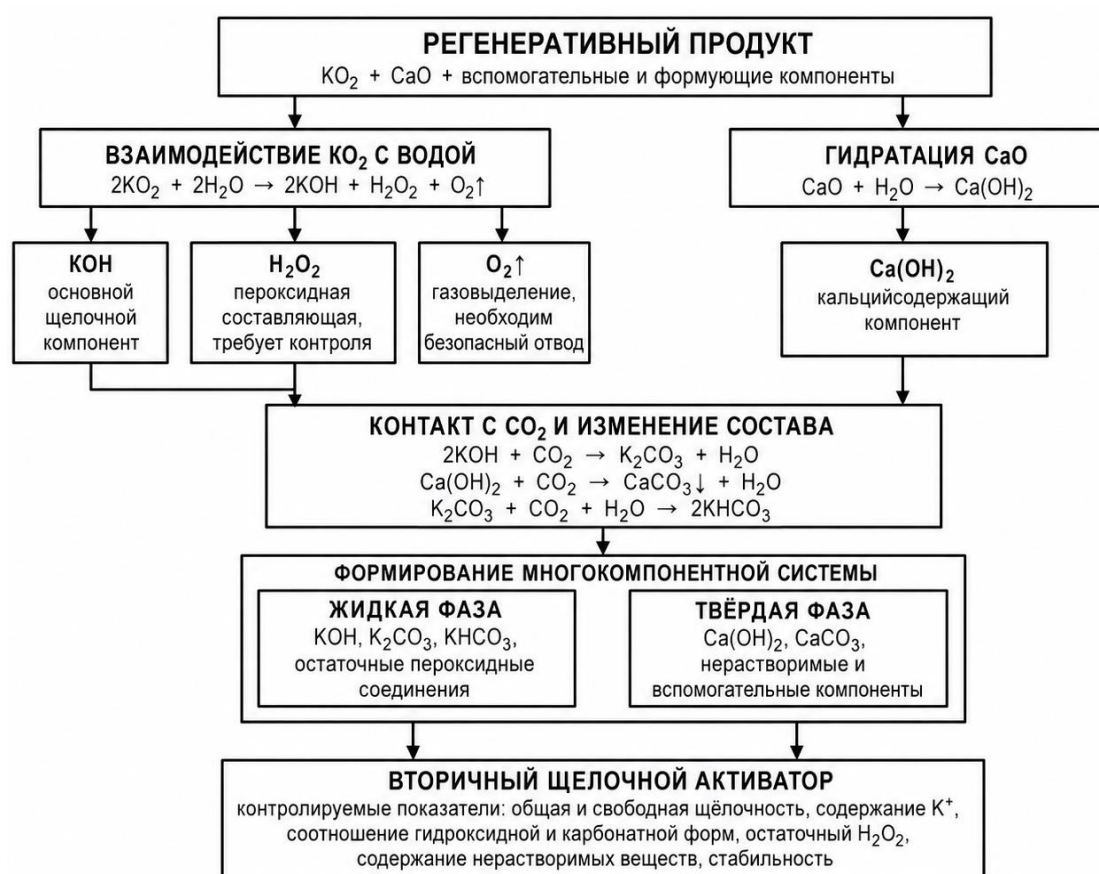
Рисунок 2 – Схема химических превращений компонентов регенеративного продукта при получении вторичного щелочного активатора
