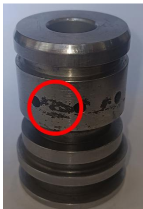
Рисунок 3 – Результат износа при недостаточной смазываемости
